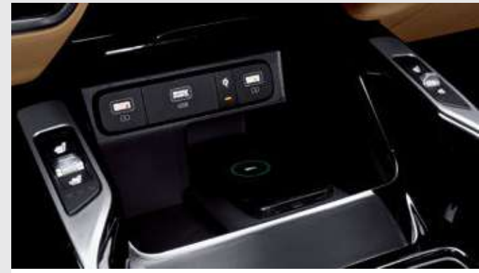
스마트폰 무선충전 시스템 무선 충전 기능을 지원하는 스마트폰을 별도의 케이블 연결 없이 충전 패드 위에 올려두는 것으로 편리하게 충전 가능한 첨단 편의 장치입니다. ※ 스마트폰 기종에 따라 별도의 충전 패드 또는 충전 커버가 필요할 수 있으며, 별도 수선장치 장착 불가 기종은 이용이 어려울 수 있습니다.
