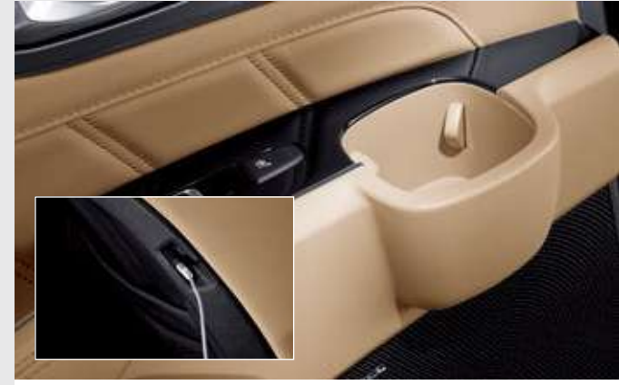
도어 암레스트 컵홀더 & 1열 시트백 USB 단자 (충전용) 2열 도어 암레스트 전방에 컵홀더를 적용하여 후석 탑승객의 수납 편의성을 향상했습니다. 또한 1열 시트백에 충전이 가능한 USB 단자를 장착하여 탑승객의 전자기기 사용 편의성을 증대하였습니다.
