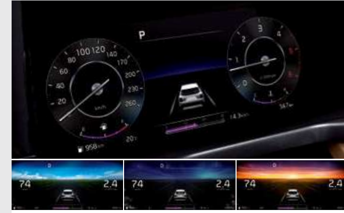
슈퍼비전 클러스터 (12.3인치 풀사이즈 칼라 TFT LCD) 풀사이즈 칼라 TFT LCD 화면을 통해 드라이브 모드 전환 시 다양한 애니메이션 효과를 구현하여 운전의 즐거움을 한층 더했으며 다양한 운행 정보를 최상의 시인성으로 전달해 안전한 주행 환경을 제공합니다.
