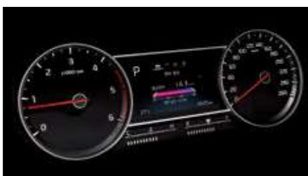
슈퍼비전 클러스터 (4.2인치 칼라 TFT LCD)
