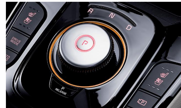
전자식 변속 다이얼 (SBW) 변속기와 다이얼 SBW가 전자통신으로 작동하는 시스템으로, 진동이 없고 작은 조작력과 동선만으로 변속이 가능하여 편의성이 뛰어납니다. ※ 6가지 컬러 구현
