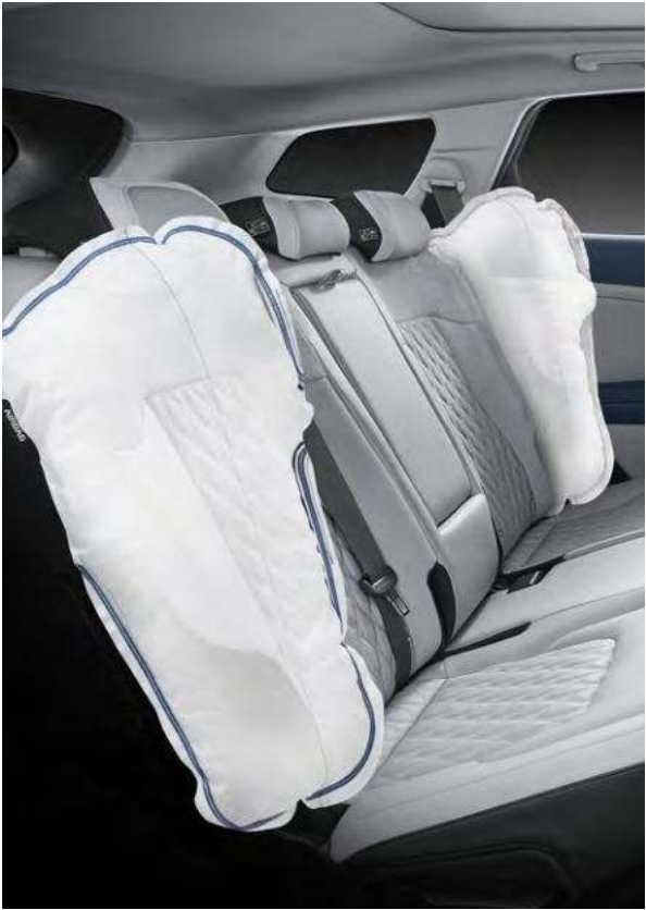
2열 사이드 에어백 * 새롭게 적용된 2열 사이드 에어백을 포함해, 운전석/동승석 어드밴스드, 전복 감지 커튼, 1열 사이드 에어백까지 총 8개의 에어백으로 상해를 최소화합니다.
