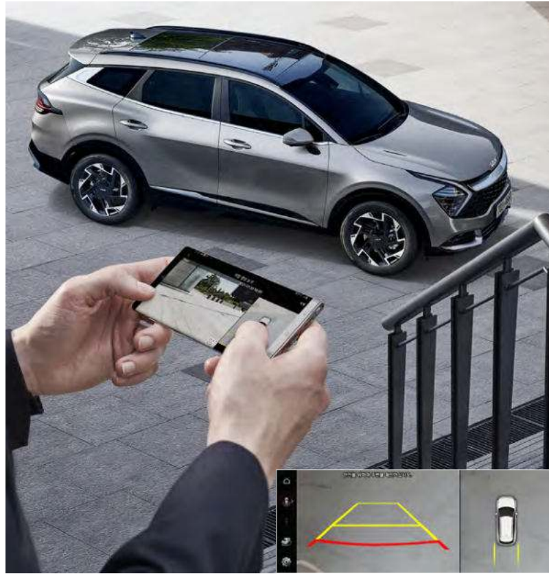
리모트 360도 뷰 (내 차 주변 영상) 운전자가 멀리 떨어진 상황에서도 스마트폰의 Kia Connect 애플리케이션을 통해 원격으로 차량 주변 상황 및 차량 상태를 확인할 수 있는 기능입니다. 서라운드 뷰 모니터 안전한 주차를 위해 차량 주변의 상황을 영상으로 보여줍니다.
