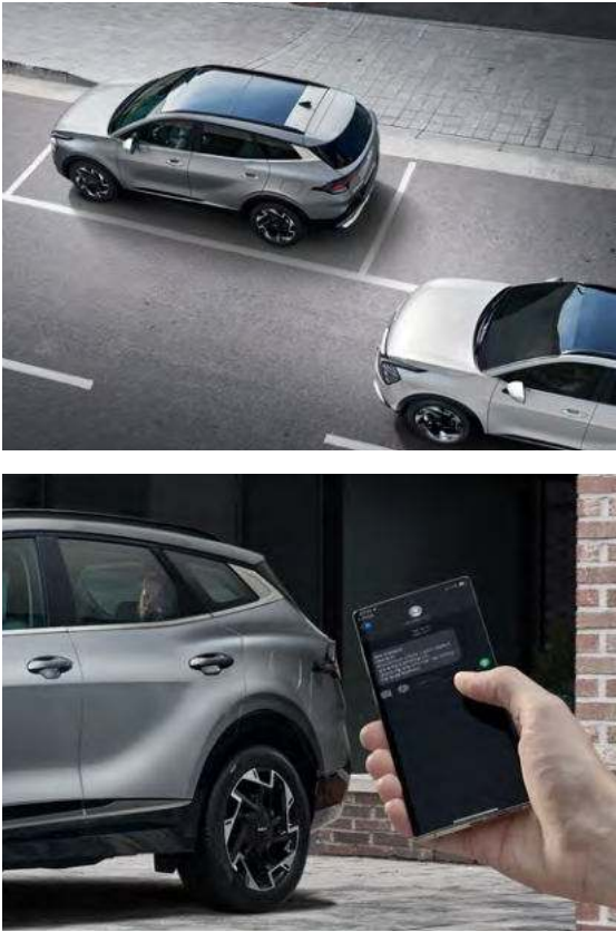
안전 하차 경고 정차 후 탑승자가 내리려고 도어를 열 때, 후측방에서 접근하는 차량이 감지되면 경고를 해줍니다. 후석 승객 알림 차량 뒷문의 개폐 여부와 차량 내 레이더 센서를 통해 후석 승객의 유무를 판단한 뒤, 클러스터 경고 메시지, 경고음 뿐만 아니라 Kia Connect 문자 메시지 등으로 운전자에게 알림을 주어 운전자가 후석을 확인하도록 도와줍니다.
