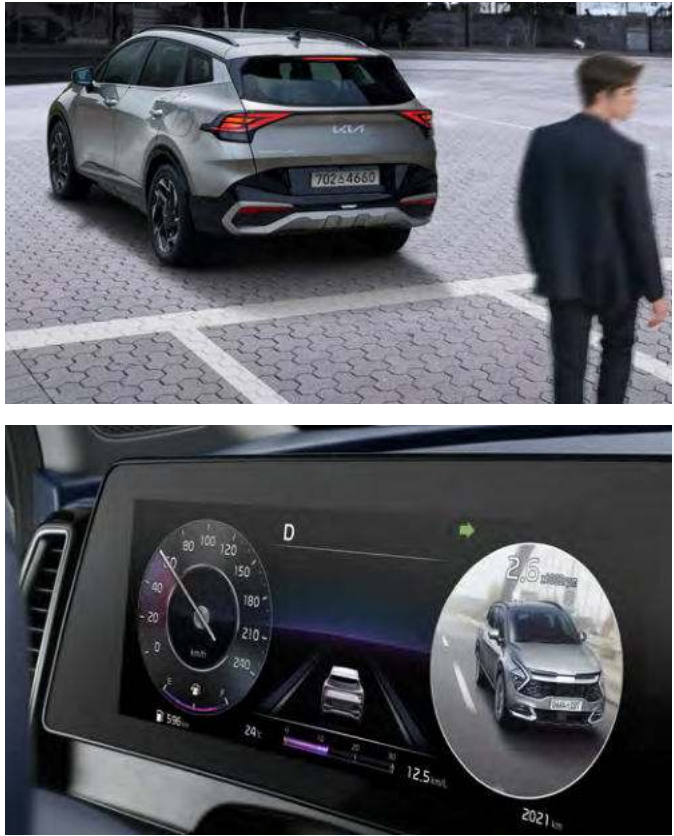
후방 주차 충돌방지 보조 후진 중 후방 보행자 또는 물체와 충돌 위험이 감지되면 경고를 해주고, 경고 후에도 충돌 위험이 높아지면 자동으로 제동을 도와줍니다. 후측방 모니터 방향지시등 스위치를 조작하면 해당 방향의 후측방 영상을 클러스터에 표시해줍니다.
