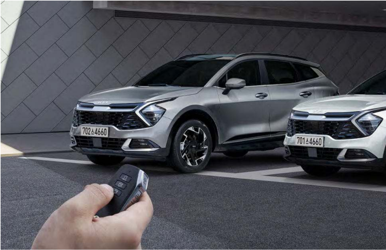
원격 스마트 주차 보조 차량 외부에서 차량을 전진 또는 후진 제어하여, 원격으로 주차 및 출차하도록 도와줍니다. ※ 운전자가 차량 주변 약 4m 이내 위치 시 작동 가능, 이동 거리는 1회당 최대 7m (총 2회 14m까지 이동 가능) ※ 디젤, 하이브리드, LPG 적용
