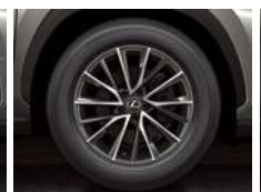
NX 450h+ Premium Dark Gray Metallic + 다이아몬드 커팅(투톤) 알루미늄 휠 235/60R 18 (EMT)
