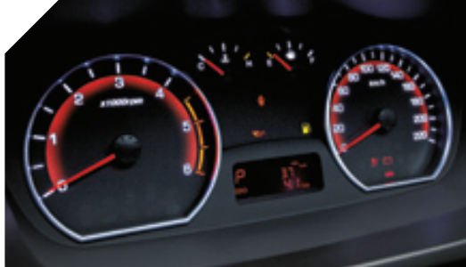
1. 클러스터 중앙의 LCD 창에 평균연비, 순간연비를 나타내는 트립 컴퓨터
