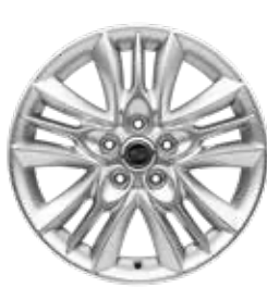
17인치 알로이 휠 (타이어 : 225/60R17) * 다절 6단 수동 변속기 선택시 저마찰 연비형 P215/65R17타이어로 변경 적용됨
