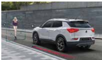
제동보조 장치 BAS(Brake Assist System) 급제동 시 브레이크의 압력을 증대시켜 제동거리를 줄이고 사고를 방지해 줍니다.
