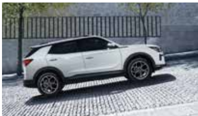
언덕 밀림 방지장치HSA(Hill Start Assist) 언덕에서의 출발 시 브레이크에서 발을 떼어도 차가 밀리지 않도록 브레이크 압력을 일정 시간 유지시켜 줍니다.
