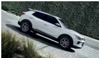
경사로 저속 주행장치 가변형 HDC (Hill Descent Control) 급경사 주행 시, 자동 저속 주행 장치가 작동되어 급가속 되지 않도록 속도를 조절해 줍니다.
