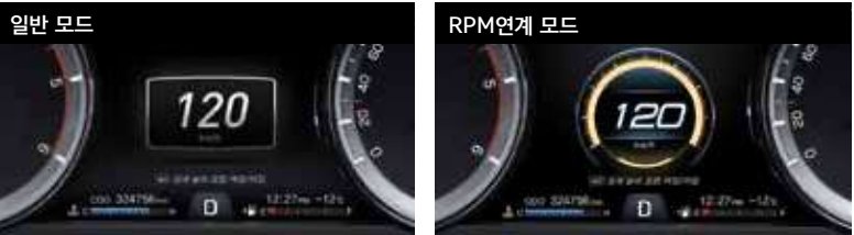
7인치 대화면 슈퍼비전 클러스터 7인치 대화면 TFT LCD창을 통해 다양한 콘텐츠를 클러스터에 표시해 주며, 3가지 모드의 디지털 스피드 화면을 적용하였습니다.
