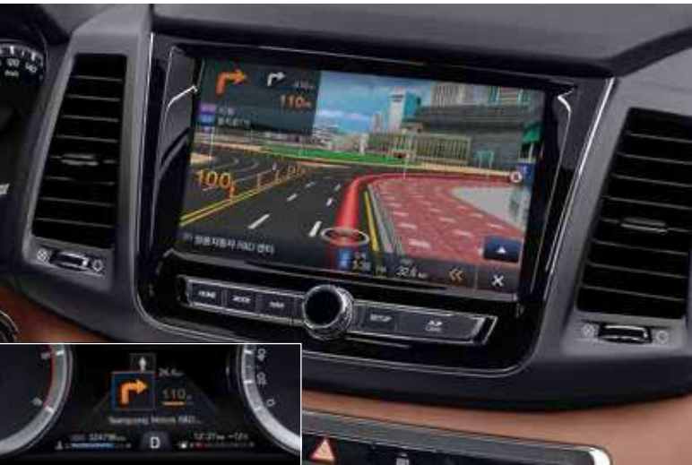
내비게이션 연동 클러스터 내비게이션과 클러스터가 연동하여 차량이 가야 할 방향을 클러스터에 표시해 줍니다.
