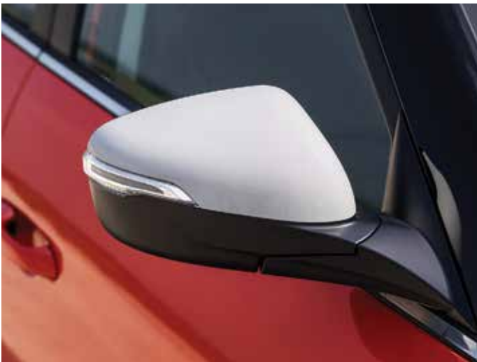
FULL LED 헤드램프 (LED DRL, LED 턴시그널 램프, LED 로우빔/하이빔) 아웃사이드 미러(LED 방향지시등, 열선, 전동조절, 전동접이)
