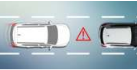
급제동 비상 경보장치 ESS (Emergency Stop Signal) 차량 급정거 시 비상등을 자동으로 점등시켜 뒷차에게 위험을 알려줍니다.
