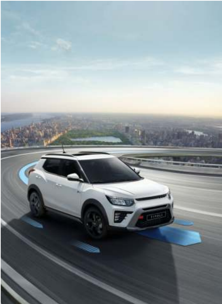
차량전복 방지장치 ARP (Anti-Rollover Protection) 고속주행 중 급선회 구간에서 각 바퀴의 브레이크와 엔진출력을 조절하여 차량의 전복을 방지시켜 줍니다.
