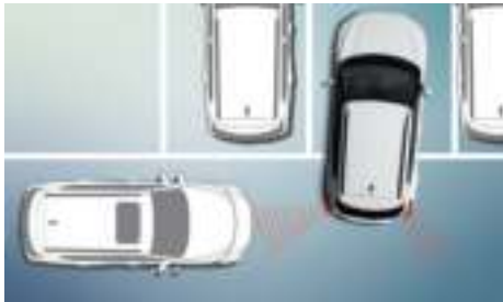
후측방 접근 경고 RCTW (Rear Cross Traffic Warning) 후측방 접근 충돌 보조 RCTA (Rear Cross Traffic-Collision Assist) 주차 중이거나 후진 주행 시 센서가 차량에 접근하는 물체를 감지하면 운전자에게 위험을 경고해 주고, 긴급 제동하는 기능입니다.
