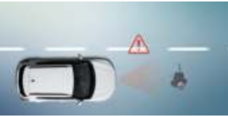
제동보조 장치 BAS (Brake Assist System) 급제동 시 브레이크의 압력을 증대시켜 제동거리를 줄이고 사고를 방지해 줍니다.
