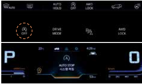
ISG 시스템 (공회전 제한 장치) 정차 시 브레이크 페달을 밟으면 자동으로 엔진을 정지시켜 공회전을 방지하고 연비 향상을 도와줍니다.
