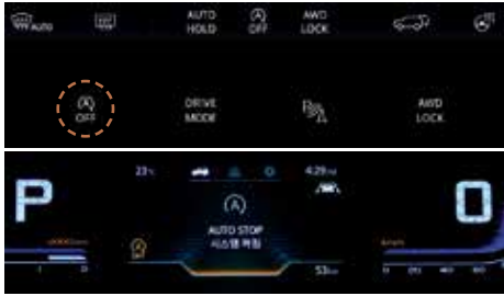
ISG 시스템 (공회전 제한 장치) 정차 시 브레이크 페달을 밟으면 자동으로 엔진을 정지시켜 공회전을 방지하고 연비 향상을 도와줍니다.
