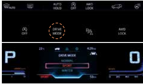
드라이브 모드 시스템 다양한 드라이브 모드 (NORMAL/SPORT/WINTER)로 운전자의 성향에 맞는 주행 퍼포먼스를 제공합니다.
