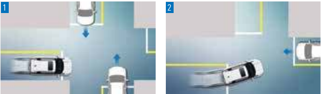
1. 교차로에서 교차 차량 감지 시 경고 후 긴급 제동해 줍니다. 2. 교차로에서 좌/우회전 시 직진으로 접근하는 차량 감지 시 경고 후 긴급 제동해 줍니다.
