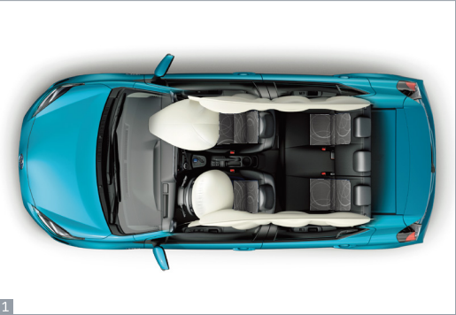
1 9개 SRS 에어백 앞좌석 쿠션 에어백 및 운전석 무릎 에어백을 포함한 총 9개의 SRS 에어백이 탑재되어 충돌이 발생했을 경우 운전자와 동승자의 피해를 줄여줍니다.
