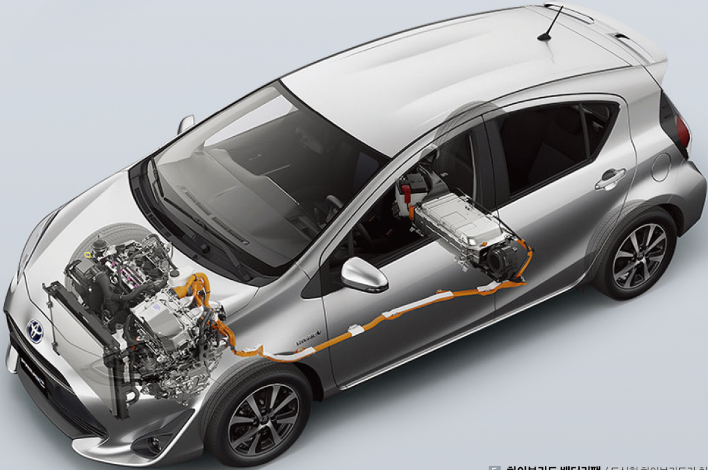
5 하이브리드 배터리팩 / 도심형 하이브리드카 차체에 최적화된 배터리팩으로 크기를 최소화시켜 배터리를 경량화하였습니다.
