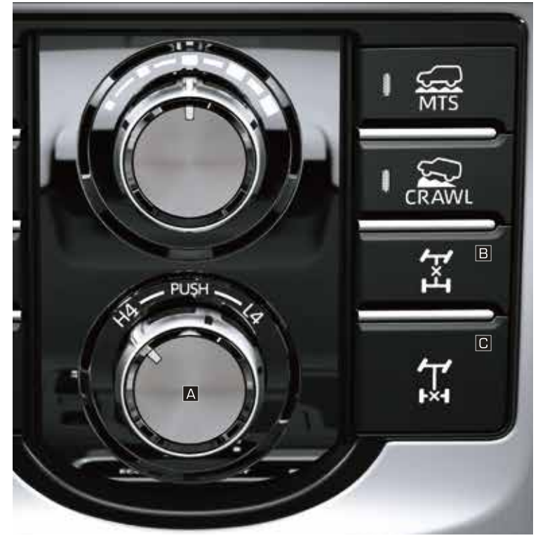
مفتاح تحويل الدفع A Transfer switch مفتاح إقفال الترس التفاضلي المركزي B Center differential lock switch مفتاح إقفال الترس التفاضلي الخلفي C Rear differential lock switch
