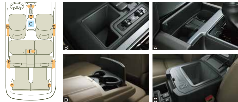
A حاملات الأكواب في الكونسول الوسطي B صينية الكونسول الوسطي C صندوق التبريد D حاملات الأكواب في مسند الذراع الوسطي E حاملات القوارير في لوحات ديكور الأبواب F حاملات أكواب
