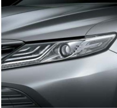
المصابيح الأمامية مزودة بمصابيح LED و مصابيح نهائية تعمل باستمرار Headlamps, consist of LED and DRL
