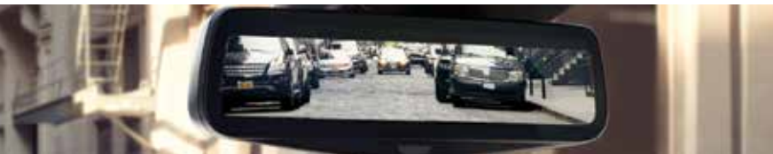
Vista trasera de la cámara de visión HD proyectada en el espejo retrovisor
