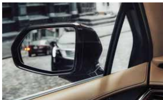
Espejos laterales eléctricos , antiempañantes y abatibles eléctricamente con alerta de sensor de obstáculos laterales
