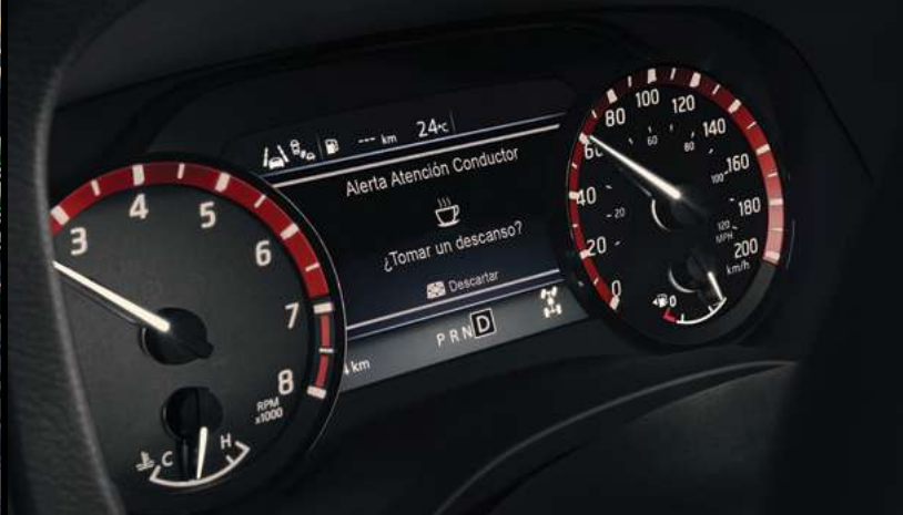
Monitor avanzado de asistencia a conductor a color de 7"
