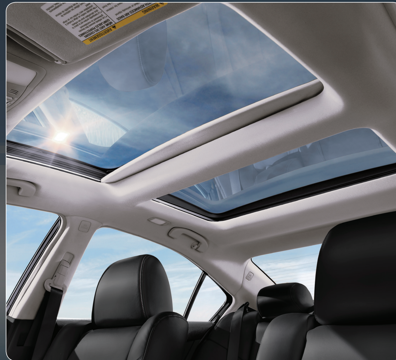
QUEMACOCOS PANORÁMICO ELÉCTRICO CON APERTURA Y CIERRE DE UN SOLO TOQUE Y SISTEMA ANTIOPRESIÓN
