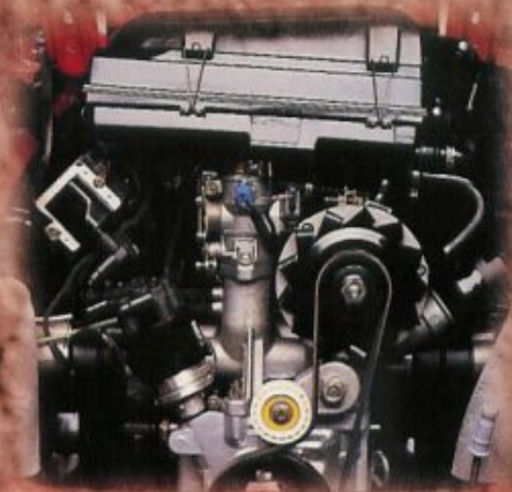
Motor 1.6 litros con alternador de 51 AMP
