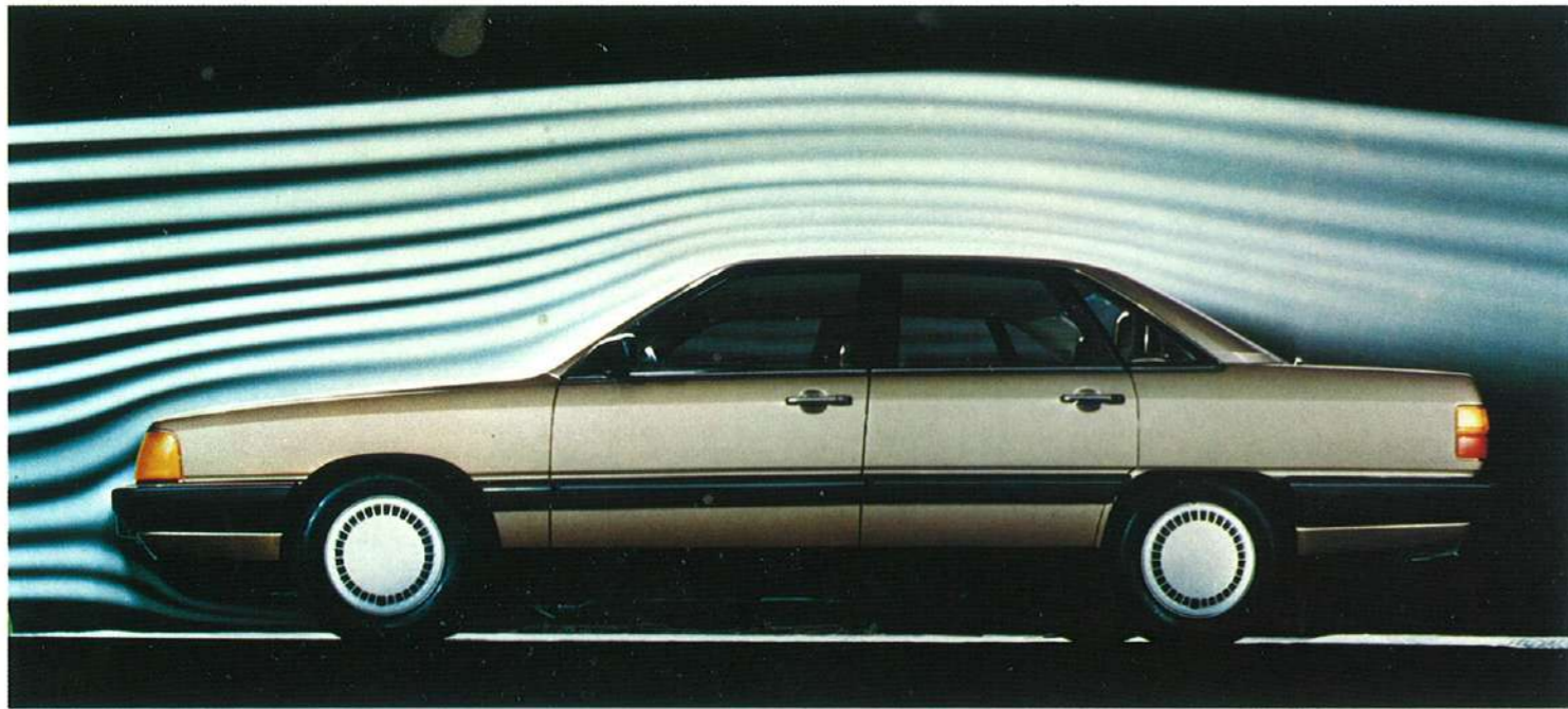
De nieuwe Audi 100 heeft als eerste seriewagen ter wereld een luchtweerstandscoefficiënt ( C_w ), van slechts 0,30.
