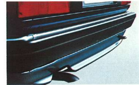
Onder de achterbumper bevindt zich een tweede luchtgeleider.
