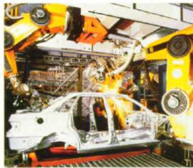
robots lassen het dak
