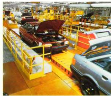
montagestation met platform
