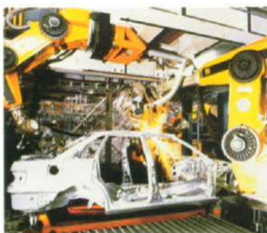
robots lassen het dak
