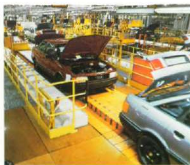
montage station met platform
