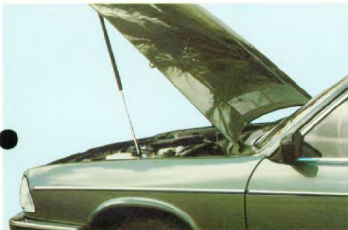
Gasgevulde motorkapsteun. (GL)
