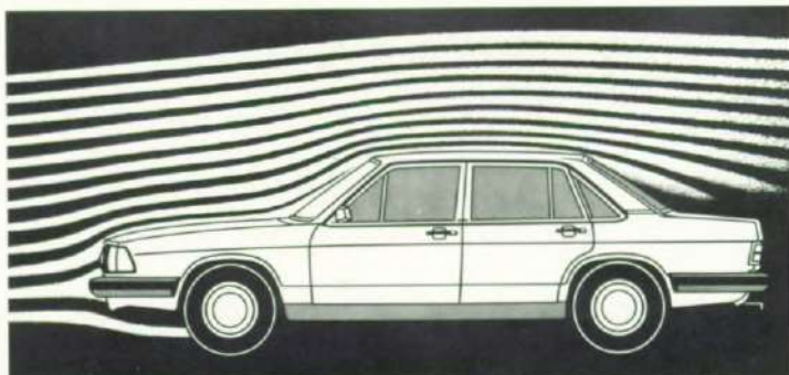
De ideale aerodynamische vorm is het resultaat van langdurige proefnemingen in de windtunnel.
