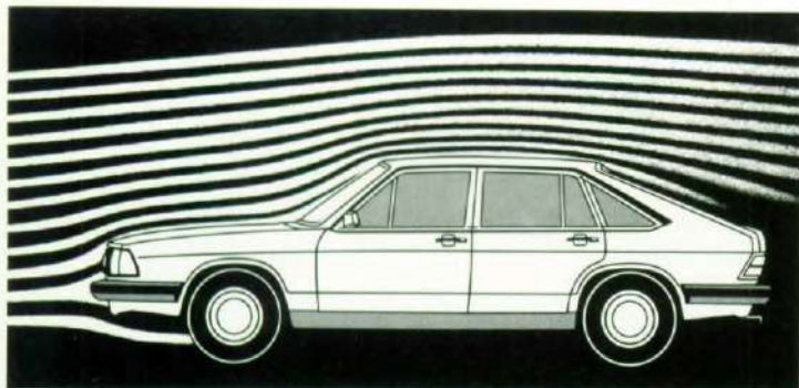
De geringe luchtweerstand is het resultaat van langdurige proeven in de windtunnel.
