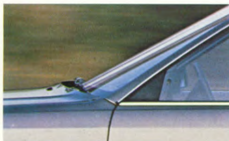
De gunstige stand van de voorruit draagt in belangrijke mate bij aan de goede aërodynamiek van de nieuwe Audi 100.
