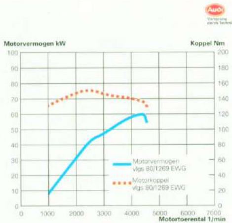
Het vermogen van de 60 kW motor.
