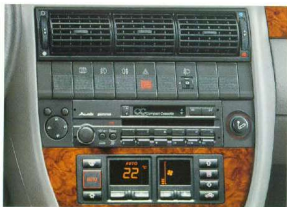
De bedieningselementen voor verwarming en ventilatie.
