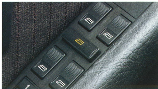
Paneel voor de elektrisch bedienbare zijruiten in de armsteun van het bestuurdersportier.
