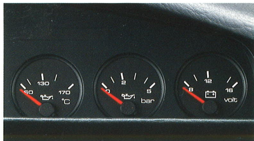
Extra instrumenten in het dashboard. Voltmeter, oliedruk- en olietemperatuurmeter (niet voor Diesel).
