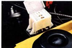
De diagnose-stekker verbindt de Audi 80 met het AUDI NSU-Computer Diagnose Systeem.
