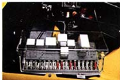
De elektrische centrale geeft de mogelijkheid om snel zekeringen, relais en getransistoriseerde schakelcircuits te verwisselen.
