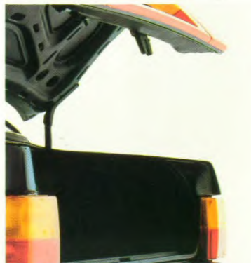
2 gasdrukveren voor de bagageklep
