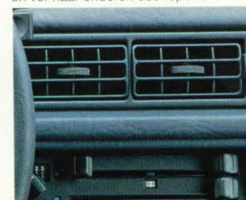
Verwarmings- en frisseluchtinstallatie met drietrapsventilator
