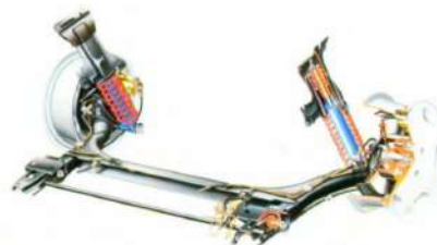
De nieuwe achterasconstructie van de Audi 80.
