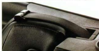
Rollmechanisme van de veiligheidsgordel zorgt voor meer draagcomfort voor de achterpassagiers.
