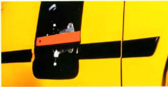
Extra bescherming bij aanrijdingen in de flanken door sterke veiligheidsbalken die in de portieren zijn aangebracht.
