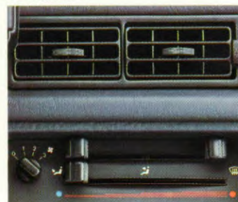
Verwarmings- en ventilatiesysteem met 3-traps ventilator
