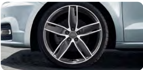
Audi Sport gegoten lichtmetalen velgen in 5-arm wing design in titaanoptiek glanzend, glanzend gefreesd 2 Maat 7,5 J x 18, banden 225/35 R 18 1 .
