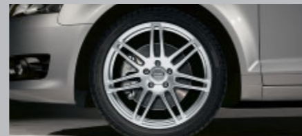
Gegoten lichtmetalen velgen Audi exclusive in 7-dubbelspaak design Maat 7,5 J x 18, banden 225/40 R 18. Van quattro GmbH
