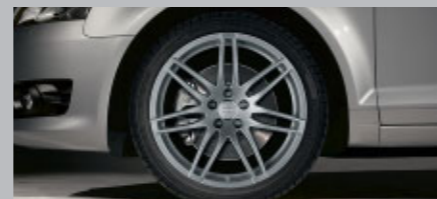
Gegoten lichtmetalen velgen Audi exclusive in 7-dubbelspaak design, titaniumkleurig Maat 7,5 J x 18, banden 225/40 R 18. Van quattro GmbH
