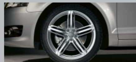
Gegoten lichtmetalen velgen Audi exclusive in 5-segmentspaak design Maat 7,5 J x 18, banden 225/40 R 18. Van quattro GmbH
