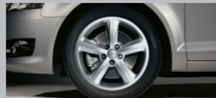
Gegoten lichtmetalen velgen Audi exclusive in 5-spaak design Maat 7,5 J x 17, banden 225/45 R 17. Van quattro GmbH
