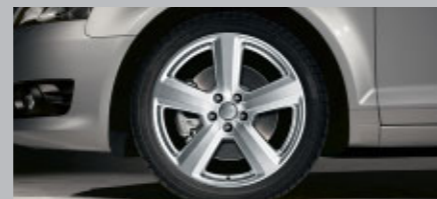
Gegoten lichtmetalen velgen Audi exclusive in 5-arm design Maat 7,5 J x 18, banden 225/40 R 18. Van quattro GmbH
