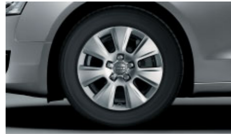
Gegoten lichtmetalen velgen in 7-arm parabool design Maat 7,5 J x 17, banden 225/50 R 17
