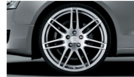
Gegoten lichtmetalen velgen Audi exclusive in 7-dubbelspaak design Maat 9 J x 20, banden 265/30 R 20. Van quattro GmbH
