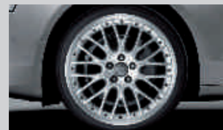
Gegoten lichtmetalen velgen in 20-spaak design 1 , tweedelig, 9 J x 19 met banden 255/35 R 19
