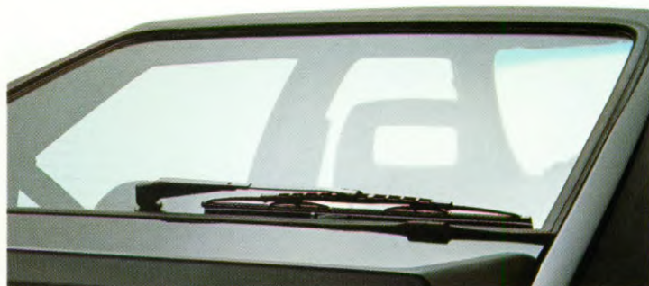
Achterraut met wis-was-installatie.
