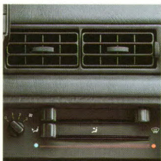
Verwarmings- en ventilatiesysteem met 3-traps ventilator.
