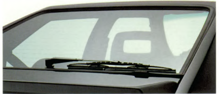
Achterraut met wis-was-installatie.
