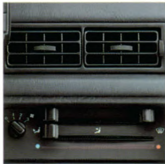
Verwarmings- en ventilatiesysteem met 3-traps ventilator.
