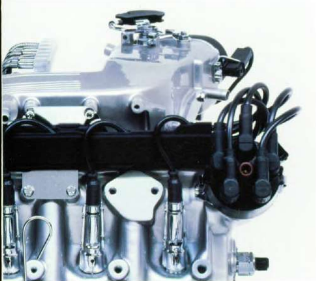
De dynamische 2,3 liter vijfcilindermotor met 98 kW (133 pk).
