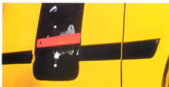
Een stevige veiligheidsbalk in de portieren kan in bepaalde ongevalssituaties helpen om de vervorming van de portieren te verkleinen.
