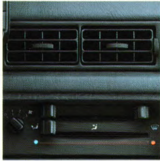
Verwarmings- en ventilatiesysteem met aanjager met drie snelheden.
