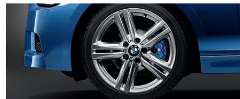
Lichtmetalen M wielen in sterspaak styling 386 M, bredere banden achter, voor 7,5 J x 18 inch met bandenmaat 225/40 R 18, achter 8 J x 18 inch met bandenmaat 245/35 R 18 (uitsluitend leverbaar in combinatie met M Sportpakket). M sportremsysteem met vaste remklauwen voorlachter in Dunkelblau, grotere remschijven en M logo (uitsluitend leverbaar in combinatie met M Sportpakket; standaard voor M135i/M135i xDrive).
