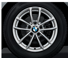
Lichtmetalen BMW wielen in V-spaa styling 378, 7 J x 16 inch, bandenmaat 205/55 R 16.
