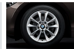
■ Lichtmetalen BMW wielen in V-spaak styling 411; 7 J x 16 inch, bandenmaat 205/55 R 16. De BMW 125i en 125d beschikken over 17-inch lichtmetalen BMW wielen in turbine styling 381.
