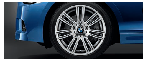
Lichtmetalen M wielen in sterspaak styling 383 M, bredere banden achter, voor 7,5 J x 17 inch met bandenmaat 225/45 R 17, achter 8 J x 17 inch met bandenmaat 245/40 R 17 (uitsluitend leverbaar in combinatie met M Sportpakket).
