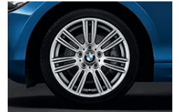
■ Lichtmetalen M wielen in sterspaak styling 383 M, bredere banden achter, voor 7,5 J x 17 inch met bandenmaat 225/45 R 17, achter 8 J x 17 inch met bandenmaat 245/40 R 17.
