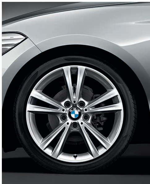
Lichtmetalen BMW wielen in dubbelspaak styling 385, bredere banden achter, voor 7,5 J x 18 inch met bandenmaat 225/40 R 18, achter 8 J x 18 inch met bandenmaat 245/35 R 18.
