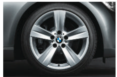
Lichtmetalen BMW wielen in sterspaak styling 189 , bredere banden achter, voor 8 J x 18 inch en bandenmaat 225/40 R 18; achter 8,5 J x 18 inch en bandenmaat 255/35 R 18, inclusief slotbouten.
