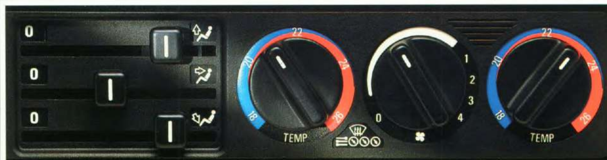
Elektronisch geregelde verwarming en luchtverversing. Voor bestuurder en passagier gescheiden regelbaar. Perfecte verdeling van de lucht. Krachtige, geruisarme en traploos regelbare radiaalventilator.
