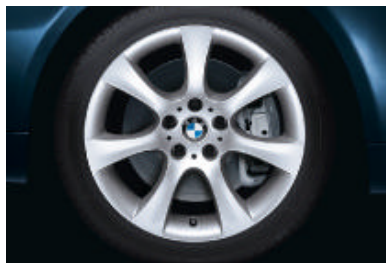
Lichtmetalen BMW wielen in sterspaak styling 124 , 8 J x 18 inch, bandenmaat 245/40 R 18.
