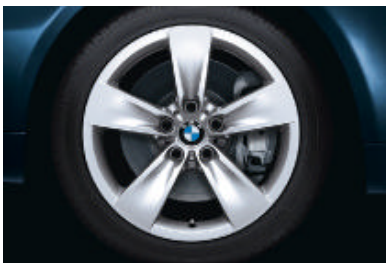
Lichtmetalen BMW wielen in sterspaak styling 246 , 8 J x 18 inch, bandenmaat 245/40 R 18.
