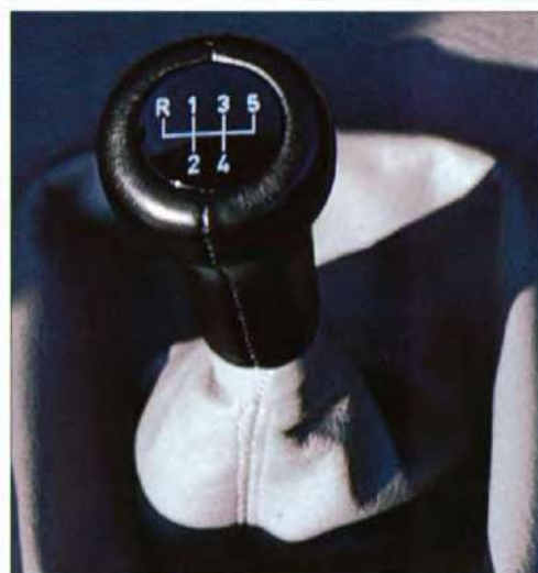
De standaard handgeschakelde 5-versnellingsbak met korte, exacte schakelwegen.
