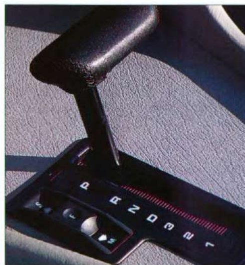
Als extra leverbaar: Automatische 4-versnellingsbak met elektronisch-hydraulische sturing (EH) en programmeerbare schakelaar: E = economy, S = sport, M = handbediening, om bij wegrijden op glad wegdek beter grip te verkrijgen.
