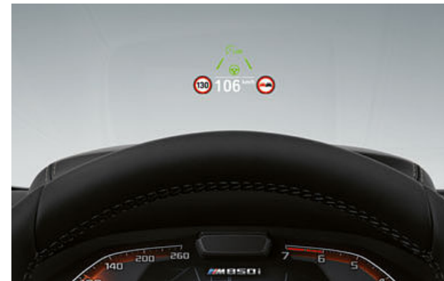
HET BMW HEAD-UP DISPLAY PROJECTEERT VOOR HET RIDEN RELEVANTE INFORMATIE ZONDER AF TE LEIDEN IN HET DIRECTE GEZICHTSVELD VAN DE BESTUURDER.
