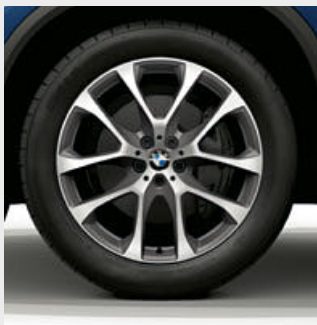
□ Lichtmetalen BMW wielen in V-spaak styling 738, uitgevoerd in Bicolor Ferricgrau, met bredere achterbanden en noodloopeigenschappen, voor 9 J x 20 inch met bandenmaat 275/45 R 20, achter 10,5 J x 20 inch met bandenmaat 305/40 R 20. 2
