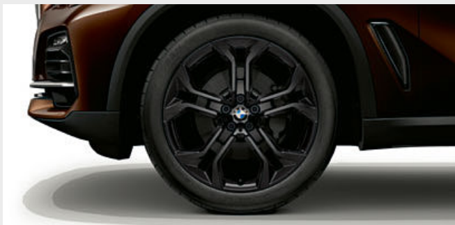
□ Lichtmetalen BMW wielen in Y-spaak styling 744, uitgevoerd in Orbitgrau, met bredere achterbanden en noodloopeigenschappen, voor 9,5 J x 21 inch met bandenmaat 275/40 R 21, achter 10,5 J x 21 inch met bandenmaat 315/35 R 21. 1
