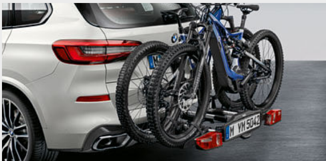
○ De BMW fietsdrager Pro 2.0 is licht en toch stabiel. Hij kan 60 kg aan. De drager is gemakkelijk in het gebruik. Er passen twee fietsen op (ook elektrische) en uitbreiding voor een derde fiets is mogelijk. De kantelfunctie maakt het gemakkelijk om bij de bagageruimte te komen.
